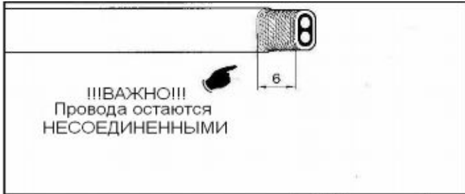
15. Неприсоединяемый конец греющего кабеля очищают от оболочки на длину 6 мм.
